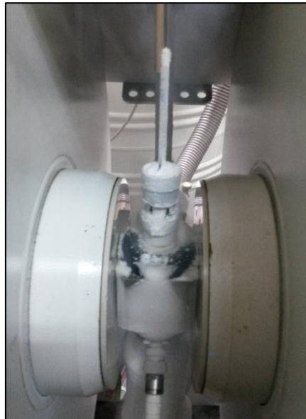
Figure 12 : Échantillon placé dans la cellule et refroidit à 110 K à l'azote liquide
