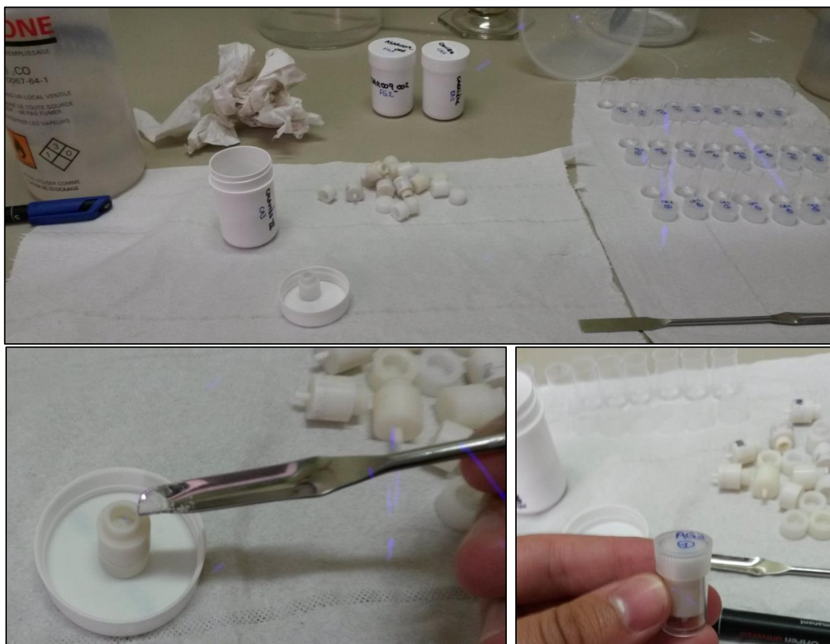
Figure 6 : Mise en piluliers des échantillons, chaque pilulier étant destiné à une dose d'irradiation différente
